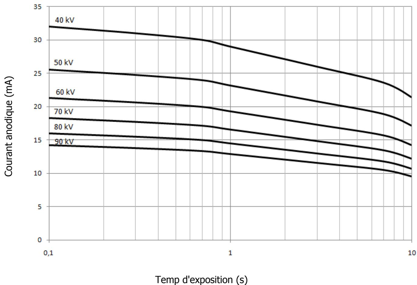
**Note:** Cette puissance a été vérifiée dans un grand réservoir d'huile. La puissance nominale peut varier en fonction de la capacité en huile et de la circulation de l'huile dans le réservoir de test.
